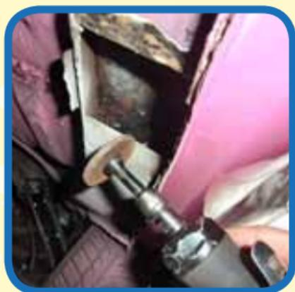
Das überlappende Lochpunktschweißen beherrscht fast jeder recht schnell der sich mit dem Schutzgasschweißgerät befasst hat. Für tragende Teile ist diese Variante eine TÜV-vorgeschriebene Pflicht unter Rostschutzaspekten aber nicht sehr wünschenswert da sich zwischen zwei Blechen schnell der Rost dauerhaft und unwiderruflich einnistet.
