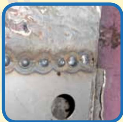
In Bild 6 ist die Nut schon gänzlich gefüllt und man erkennt gut den Unterschied zur konventionell stumpf punktgeschweißten vertikalen Naht.
