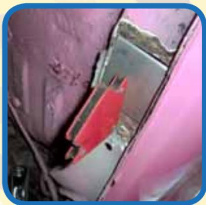
Am rechten Rand von Bild 5 erkennt man die V-förmige Nut die mit der Zange geschaffen wurde. Hier sieht man auch dass diese Nut mit Schweißpunkten quasi „aufgefüllt“ wird und schlussendlich verschliffen werden kann.
