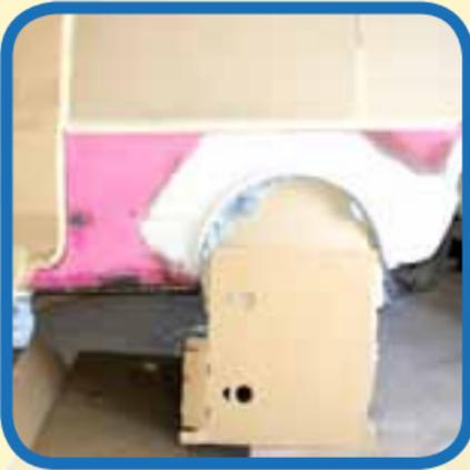
Zunächst wird alles gut abgeklebt. Wichtig ist in diesem Fall, dass auch der waagerechte Teil der Sicke mit zugeklebt wird, da dieser später für den Lackübergang...
