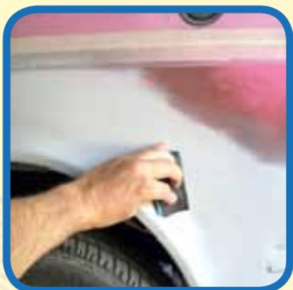
Kleine Unebenheiten und Sprühnebel werden noch mit 280er oder 400er Schleifpapier beseitigt. Wegen der leichten Wölbung ist Handschliff hierbei einfacher.
