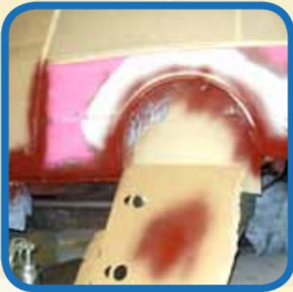
... Spritzprobe gemacht um sicher zustellen dass die Grundierung gleichmäßig aufgetragen wird und ordentlich verläuft. Zunächst werden alle Kanten grundiert um eine sichere Kantendeckung zu erreichen.
