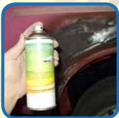
Mit KSD Kontroll-Lack in schwarz wird der gesamt geschliffene Bereich eingesprüht...
