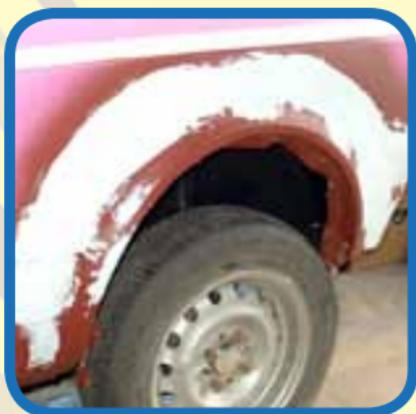
Die noch deutlich sichtbaren Unebenheiten werden mit KSD 2K-Epoxy (EP) Spachtel ausgeglichen. EP-Spachtel bleiben elastischer als Polyester-spachtel.
