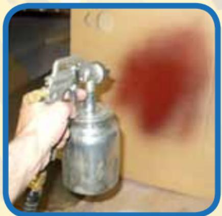
... Lackierung aufgetragen werden. Mit der spritzfertigen leicht verdünnten Grundierung wird zunächst eine ...
