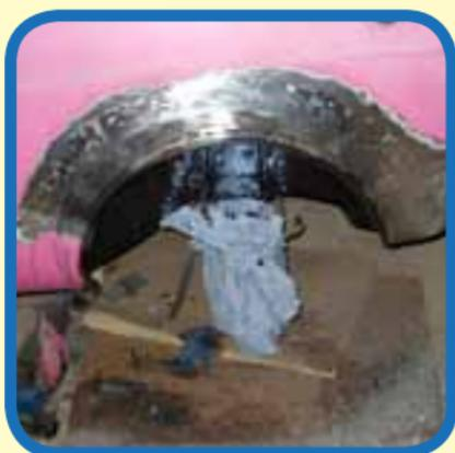
Hier wurde ein Radlauf neu eingeschweißt und verzinkt. Aufgrund des geringen Fahrzeugwertes, wurde die Verzinnung nicht ganz perfekt ausgeführt.
