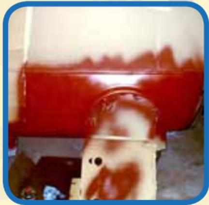
Abschließend erfolgt dann die Grundierung der gesamten Fläche. Eine einheitliche Schicht unter dem eigentlichen Decklack sorgt für ein gleichmäßiges Lackbild und verhindert das „Aufziehen“ an den Übergängen unterschiedlicher Beschichtungen unter dem Lack.
