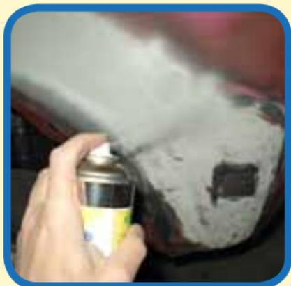
Da keine dicken Schichten zum Ausgleich mehr aufgetragen werden müssen, reicht es einen Spritzfüller aufzutragen, hier KSD Spritzfüller aus der Spraydose.
